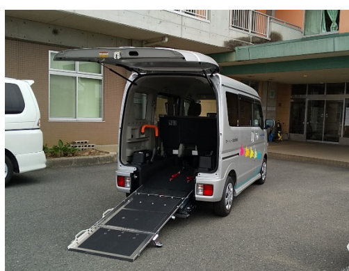
車いす用スロープ整備写真
